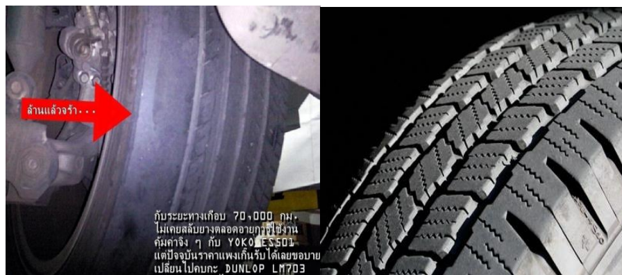
รูปที่ 2.12 ลักษณะของล้อที่มีดอกยางและไม่มีดอกยาง
