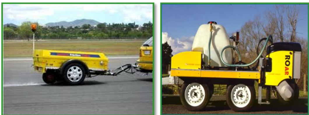
รูปที่ 2.16 รถทดสอบความฝืดแบบ Fixed Slip และ Variable Slip
