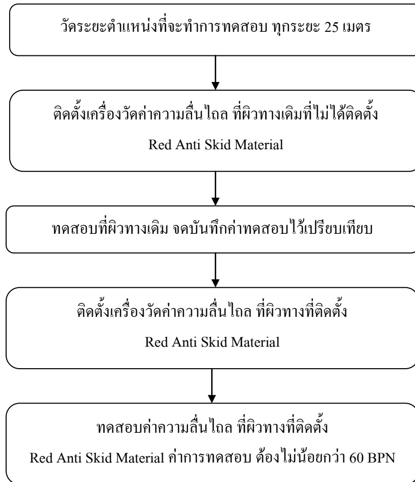
รูปที่ 2.18 ขั้นตอนการทดสอบวัสดุเคลือบผิวจราจรเพื่อลดการลื่นไถล
